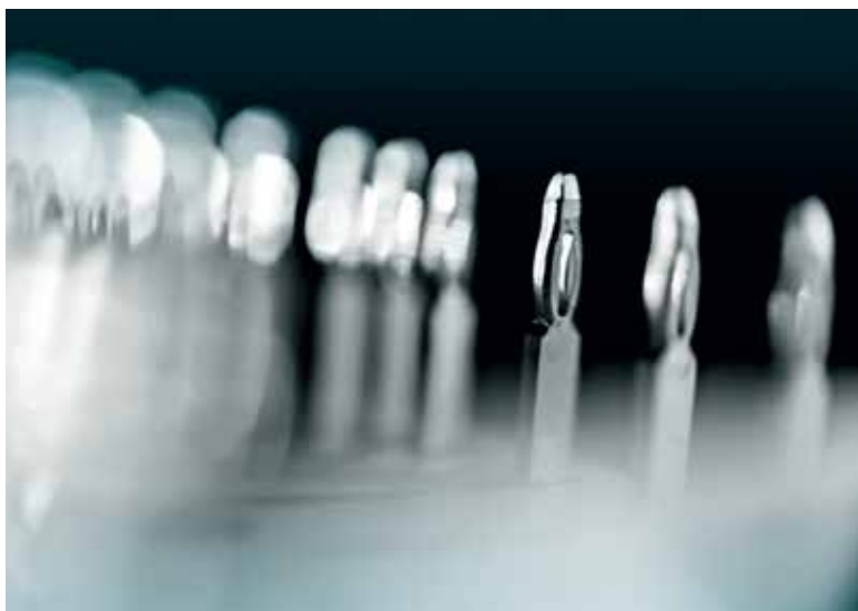
图2：用于无焊接安装的压接引脚
